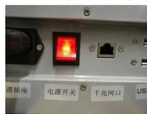
接通主机电源，按动电源开关。电源开关灯点亮。
